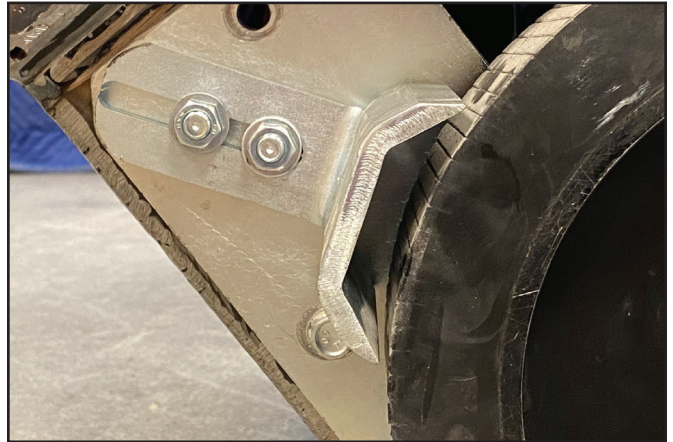
Wielreiniger op de juiste opening afgesteld.
