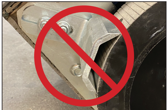
De wielreiniger mag NIET met het wiel in contact komen.
