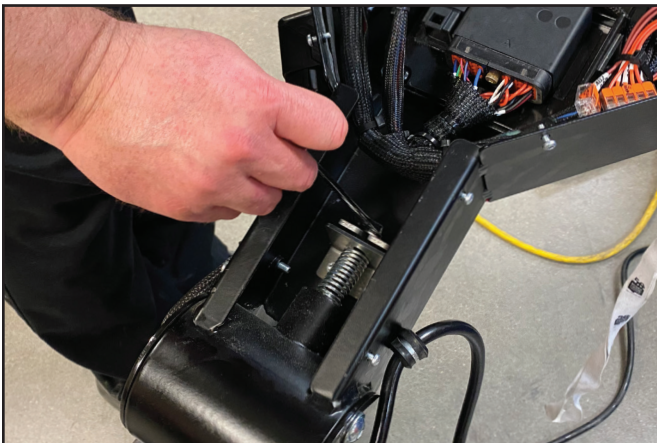
De ontgrendelingshendels van de handgreep afstellen.
