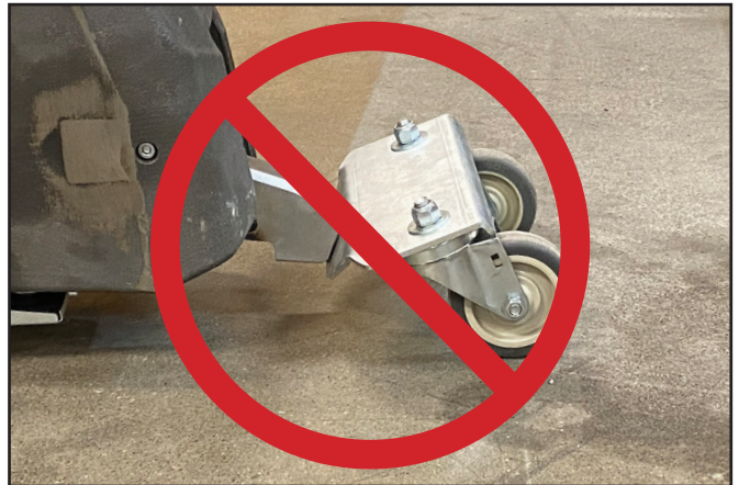
Slechte manoeuvreerbaarheid - de montagesteun is NIET evenwijdig aan de vloer.
