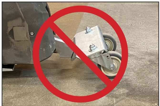
操作性が悪い - ブラケットが床と平行ではない。
