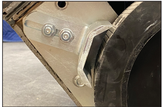
車輪クリーナーを適切な隙間に調整しました。
