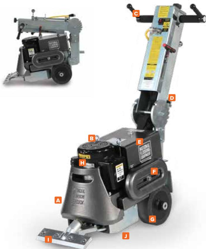
Gladiatorは、セラミックタイル、木製フロア、薄型コーティング、ビニールシート、リノリウム、その他、最近の硬い、または柔軟な頑固素材も除去できます。コンパクトなデザインは、狭い場所での使用にも最適。サイドスライドウェイトシステムにより前進時のヘッド圧を高め、後輪で動かす際のトラクションが向上します。
