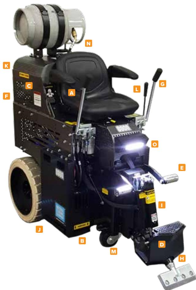
この 2842 ポンドのスクレーパーは他のメーカーのより重量の大きなマシンに匹敵します。ハイドロスタッドドライブシステム動力のスクレーパーとは異なり、8000 は特許取得のカーバイドアングルシャックテクノロジーとデュアルリフト油圧スライドプレートによる効率を融合させ、プロパンの速度およびパワーを提供します。安定したトルクが高い剥がし率を発揮し、排出量規制など厳しい品質保証プログラムもクリアしています。
