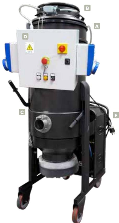
DL4000P は、DL4000 の最良の機能に加えて後退パルスコンプレッサーの利点を提供します。後退パルスコンプレッサーはフィルターを清潔に保つのに役立つため、作業場でのダウンタイムの削減につながります。
