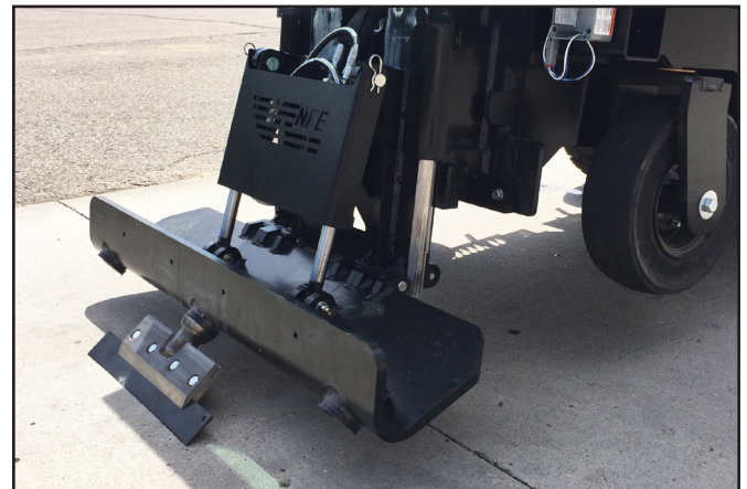
Verhoogde (steile) meskantelhoek en verlaagd mes. Voorste zwenkwielen hoog van de grond.
