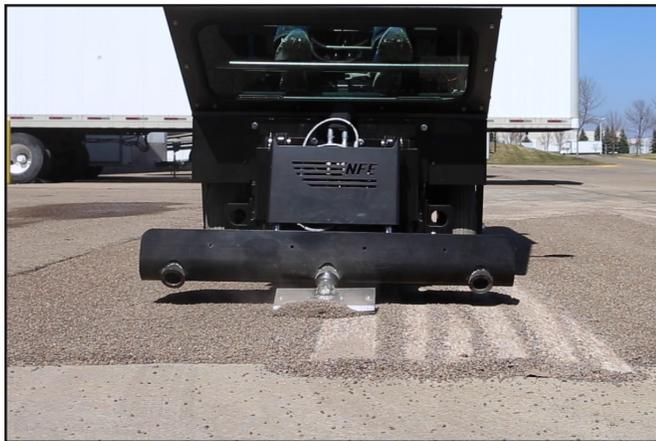
Maschine kratzt mit Epoxidharz überzogenen Beton ab.
