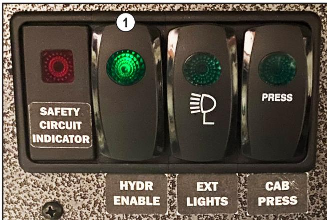
(1) Ist der Schalter für die Hydraulikaktivierung auf „EIN“, ist die Hydraulik aktiviert.
