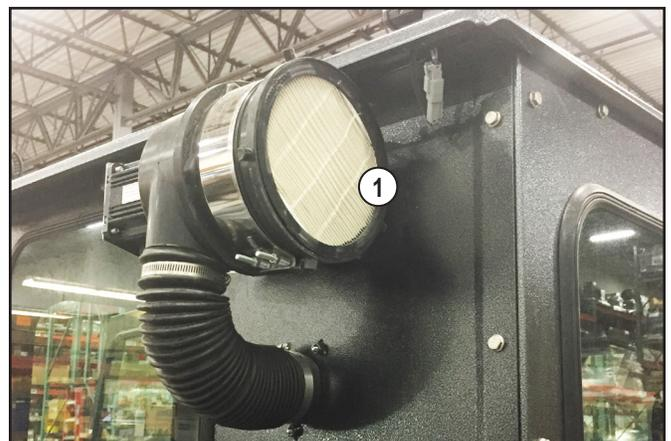
(1) Luftfilter der Kabinendruckregelung
