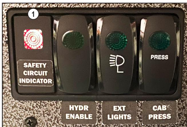
(1) Die Sicherheitsschaltkreis-Anzeige leuchtet und zeigt an, dass das Hydrauliksystem deaktiviert ist.
