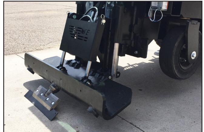
Erhöhter (steiler) Neigungswinkel der Klinge und abgesenkte Klinge. Vordere Laufräder sind hoch über dem Boden.
