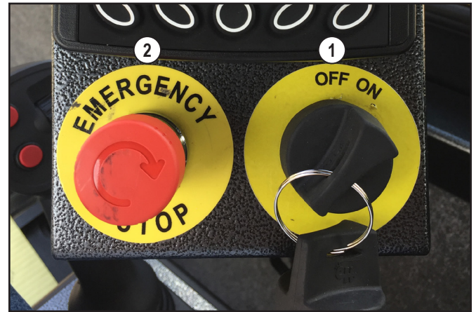
(1) Interrupteur d'allumage (2) Commutateur d'arrêt d'urgence
