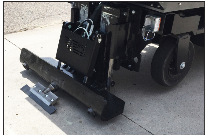
Diminution de l'angle d'inclinaison de la lame et relèvement de la lame. Roues pivotantes avant décollées du sol.
