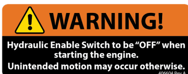
Avertissement d'activation du système hydraulique
