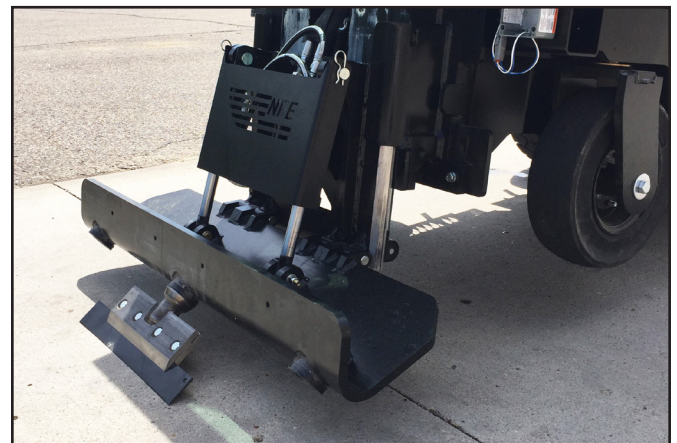
Augmentation de l'angle d'inclinaison de la lame et abaissement de la lame. Roues pivotantes avant très décollées du sol.
